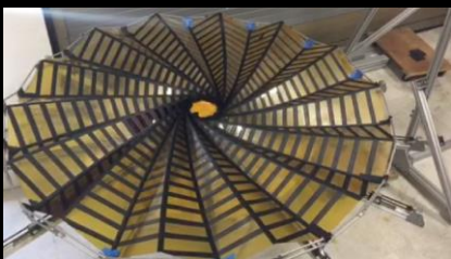
1/10-scale opaque membrane testbed (JPL)
